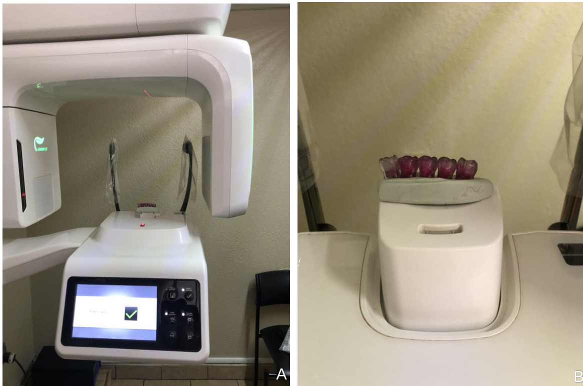
Imagen 10. Estudio de Tomografía Computarizada Cone Beam a prototipos sin instrumentar. A. Tomógrafo Computarizado PAX-Duo 3D de VATECH System Co. B. Prototipos dentales montados en silicona Spedeex en forma de hemi arcada para facilitar la obtención de imágenes tridimensionales.
