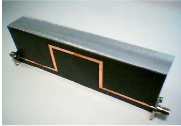
Figura 4.7 Fotografía de una línea de retardo de lazo sencillo, construida sobre un sustrato de 0.07874\text{ cm} de espesor con una permitividad relativa de 2.2 y que se encuentra doblemente terminada en conectores SMA hembra.
