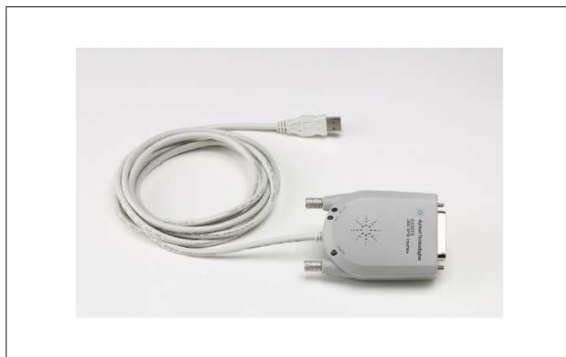
Figura 4.6: Convertidor USB a GPIB marca Agilent modelo 82357A.
