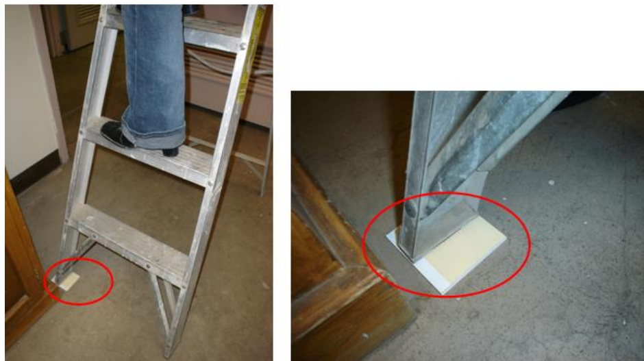
Figura 23, Imagen de la inseguridad que ofrece a los empleados la escalera utilizada en el área de administración.
