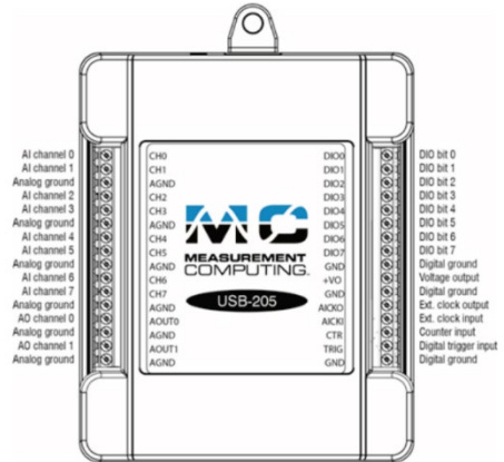
b) Diagrama de conexiones del USB 205
