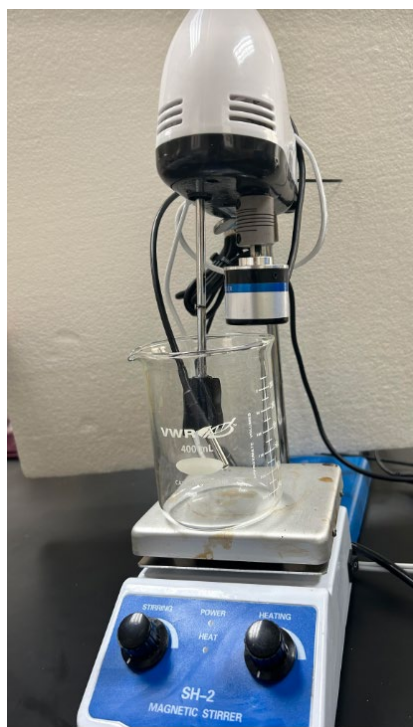
Figura 4.5. Montaje de los equipos y sensores para la reacción de transesterificación.
