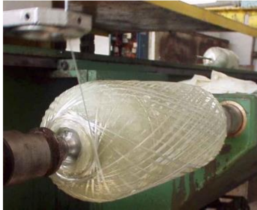
Figura 23. Proceso de bobinado de filamentos con fibra de vidrio.
