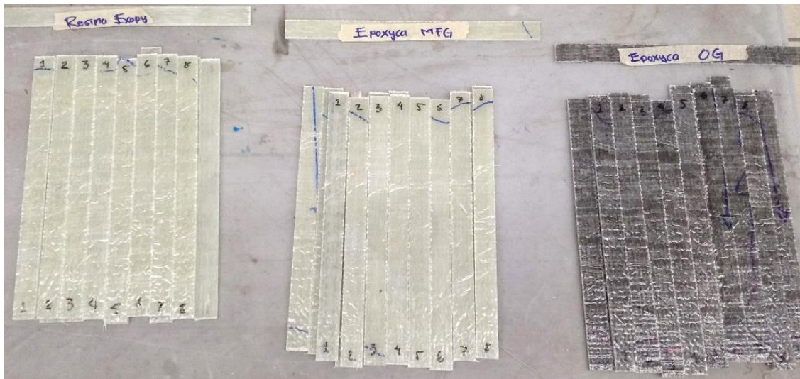
Figura 55. Probetas cortadas para la elaboración de ensayos.
