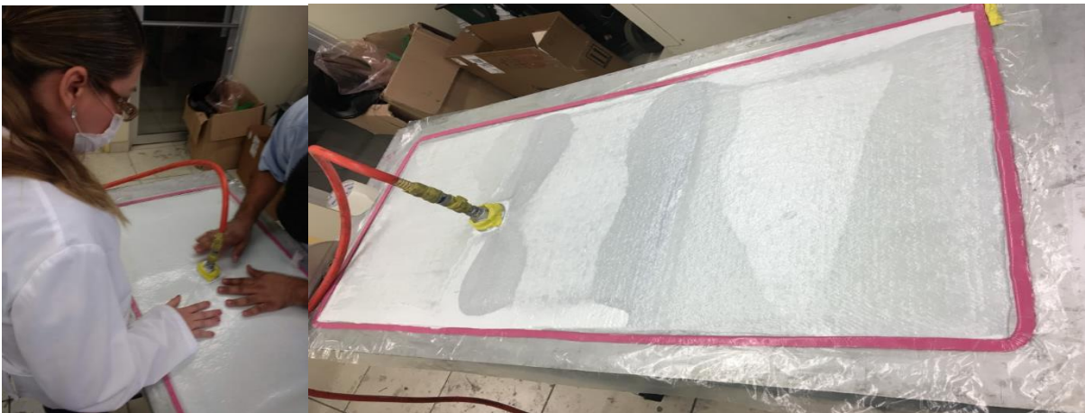
Figura 52. Colocación de válvula de vacío y eliminación de resina excedente.
