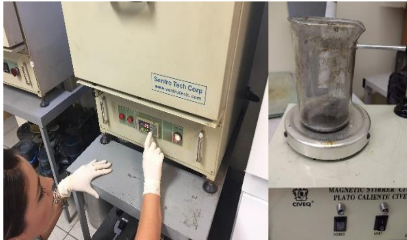
Figura 37. Proceso de secado y exfoliación de la mezcla homogeneizada.
