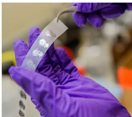
Figura 5. Exfoliación mecánica de grafeno utilizando scotch tape.
