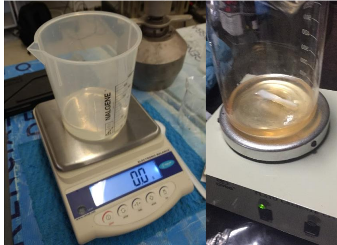
Figura 48. Peso de resina epoxi y mezclado con agitador magnético.
