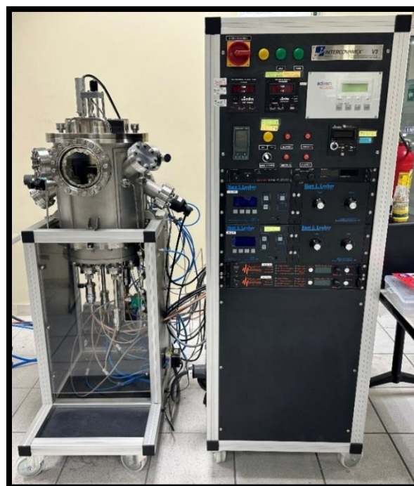
Figura 4-5. Equipo de sputtering INTERCOVAMEX V3.
