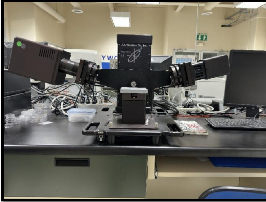
Figura 4-15 Equipo de elipsometría J.A. Woollam M-2000U.
