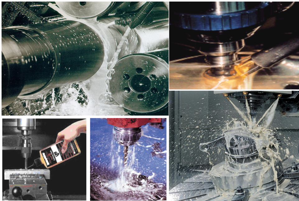
Figura 2. Fluidos de corte empleados en máquinas en la industria metal-mecánica 1,2,3,4 .
