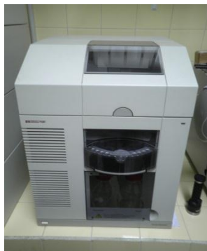
Figura 15. Equipo de electroforesis capilar HP 3D CE (Agilent Technologies, Waldbronn, Germany) equipado con un detector de fotodiiodo.
