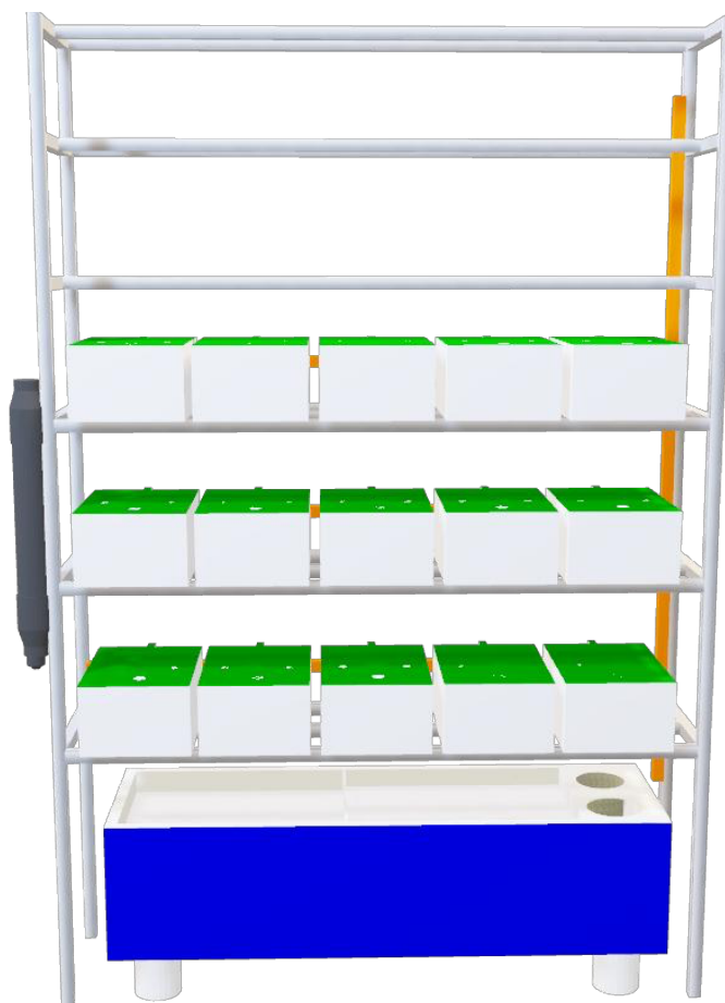
Figura 2. Diagrama del sistema de recirculación acuícola (SRA) Aquahabitat, utilizado para realizar el bioensayo de alimentación durante 114 días, con los juveniles de abulón azul ( Haliotis fulgens ).
