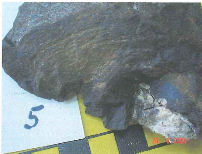
Figura 31. Laminaciones en la costra polimetálica DO1-05
