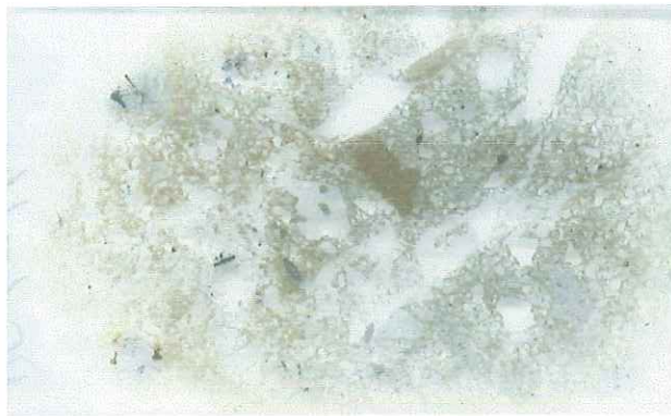
Figura 10. Lámina delgada D02-16 de Brecha sedimentaria cementada con calcita.
