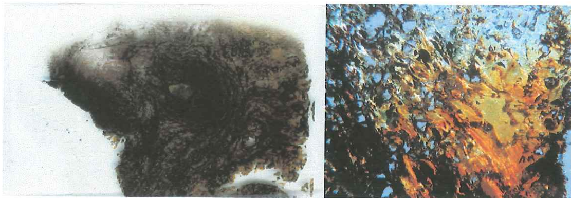
Figura 22. Lámina delgada D01-4 de Costra polimetálica (izquierda) y vista al microscopio (50x)(derecha).
