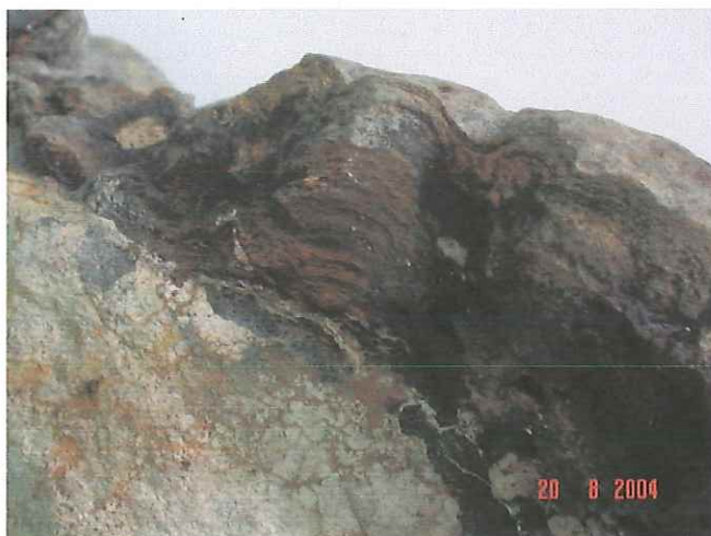
Figura 28. Laminaciones en la costra polimetálica DO2-07
