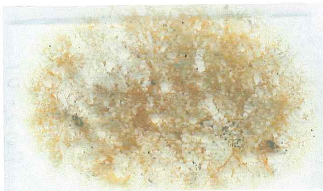
Figura 6. Lámina delgada D02-01 de Andesita de piroxenos.
