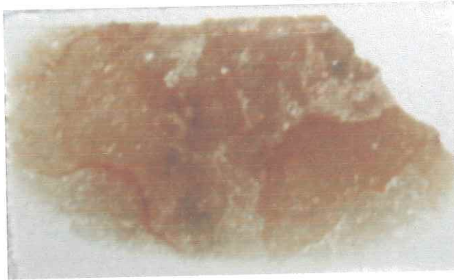
Figura 23. Lámina delgada D02-04 de Fosforita.
