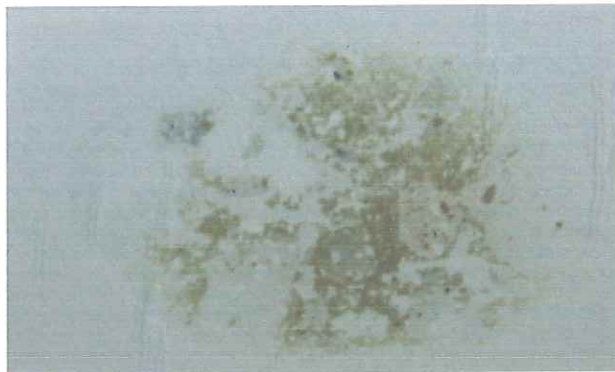
Figura 18. Lámina delgada D02-A de roca sedimentaria rica líticos.
