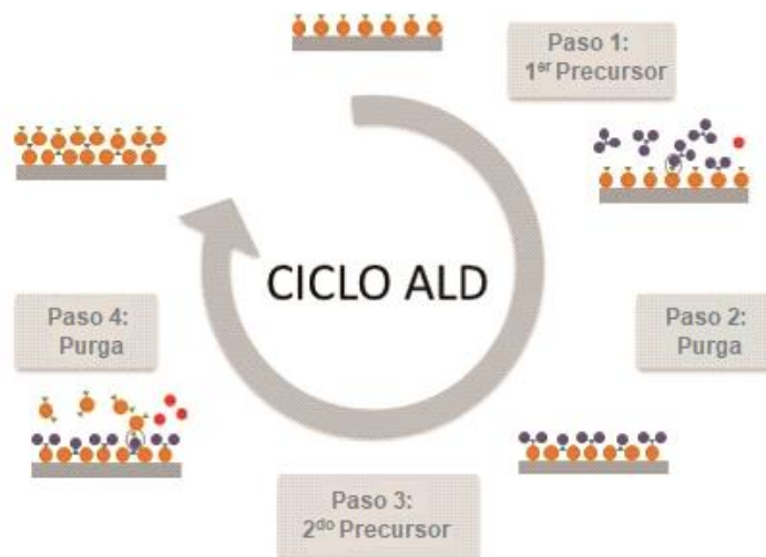
Figura 10. Esquema del ciclo ALD.
