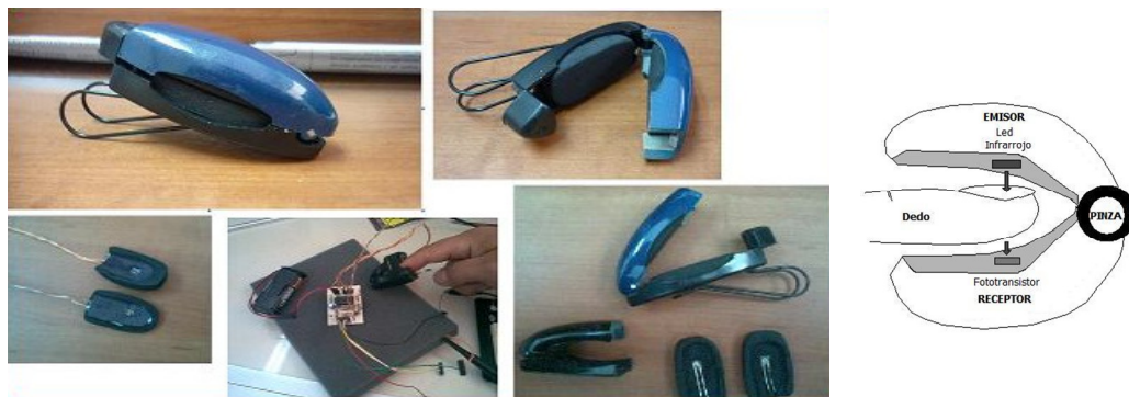
Figura 31. Diseño mejorado de la pinza.
