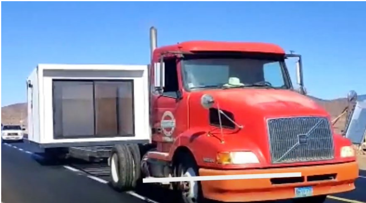
Figura 16. Cabaña fabricada con SIP de fibrocemento con refuerzo estructural, en tránsito al sitio de colocación. Fuente: ERM Thermorock, 2021.
