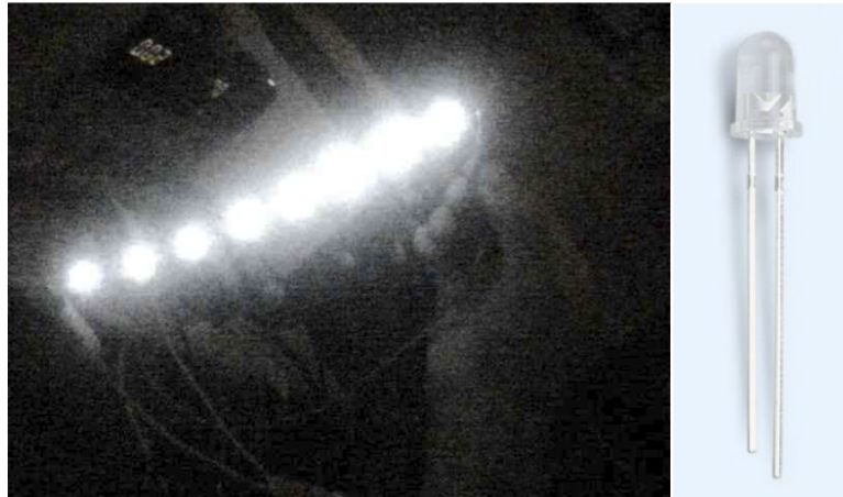
Figura 4.3.5: LEDs vistos con cámara con filtro pasa banda (izquierda) y LED infrarrojo de 850nm de longitud de onda (derecha)
