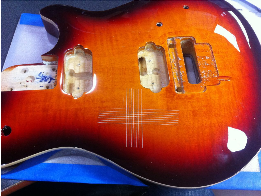
Figura 20 Muestra de prueba de adherencia mecánica sujeta a evaluación.
