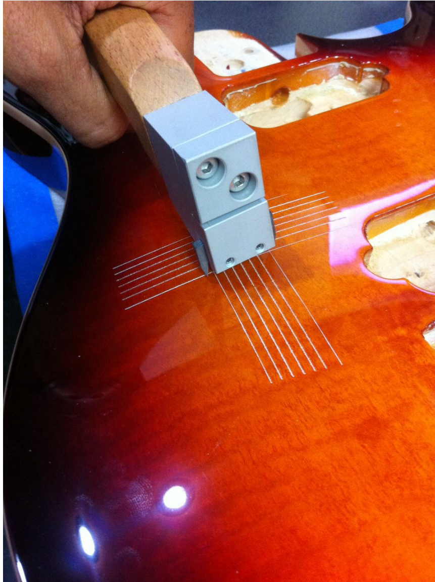
Figura 19 Equipo de rayado para prueba de adherencia.
