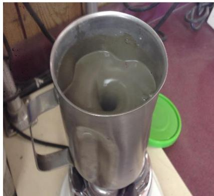
Figura 26.- Mezcla de cemento agua y aditivos
