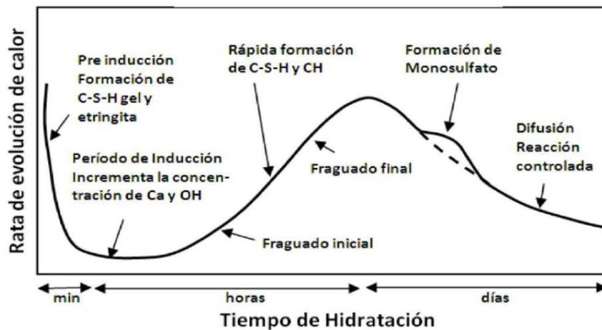
Figura 6.- Hidratación de cemento [24]
