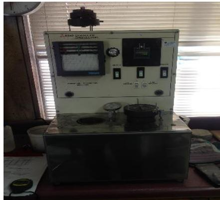
Figura 28.- Consistometro atmosférico
