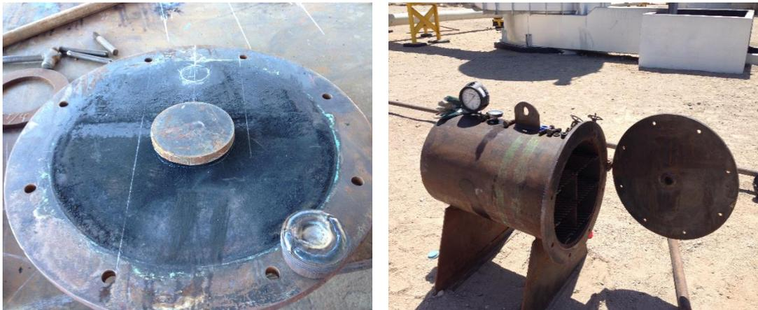
Figura 18.- Instalación de mampara para minimizar la erosión y cámara para alojar especímenes
