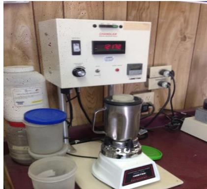
Figura 25.- Mezcladora de alta velocidad API
