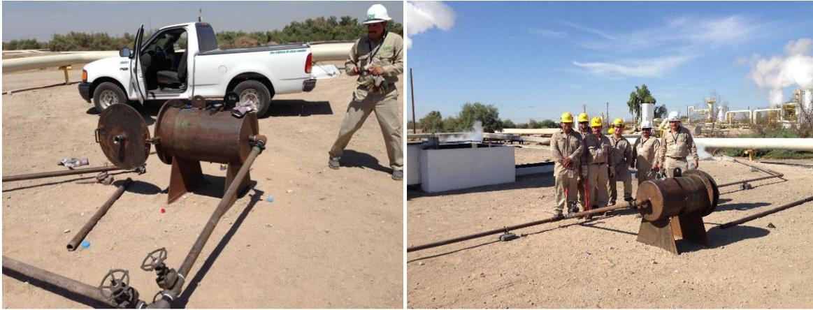
Figura 21.- Instalación de cámara de especímenes para pruebas
