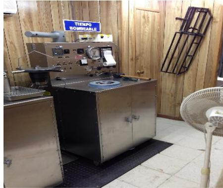
Figura 31.- Consistómetro presurizado
