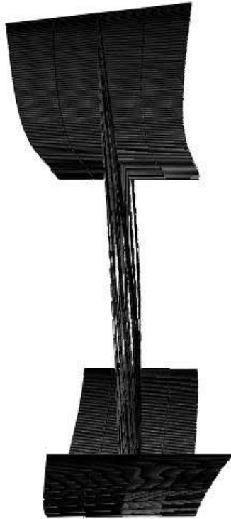
Figura 29. Incremento al punto de la falla. (Deflexión = 120.26 mm, Momento = 565.21 KN-m)
