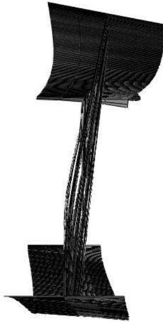
Figura 33. Incremento en el que se presenta la falla (deflexión=120.0 mm; Momento = 569.36 KN-m).
