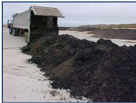
Figura 2. Residuo de ceniza de lodo de planta de tratamiento de agua
