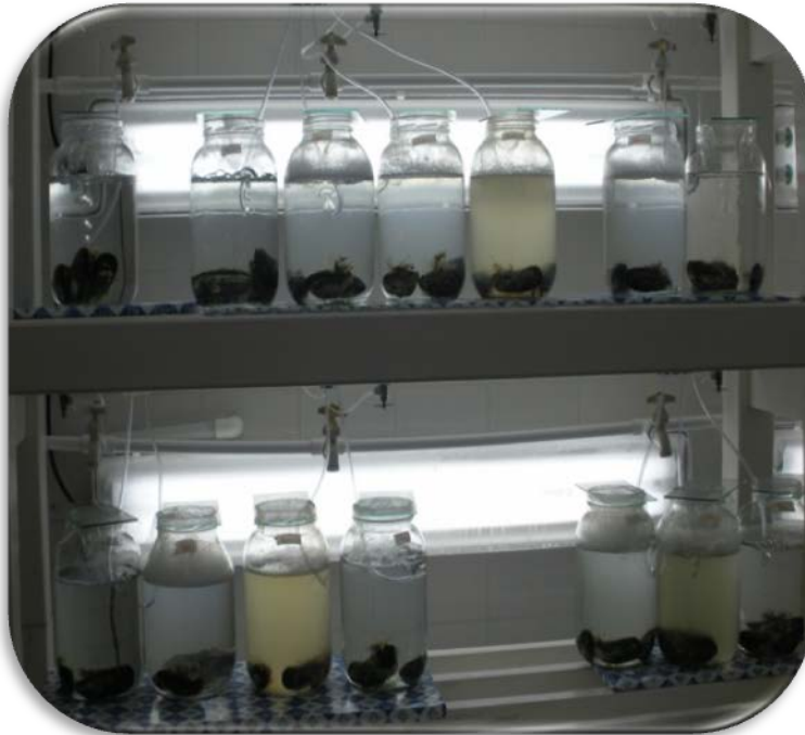
Fig. 5.-Distribución de organismos en ensayo preliminar. Los siete frascos que contienen las diversas concentraciones se encuentran distribuidos aleatoriamente.
