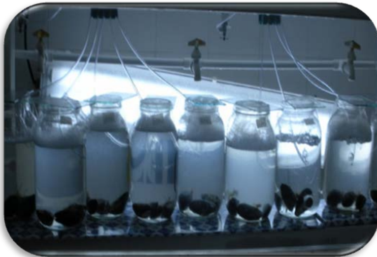
Fig. 6.- Distribución de organismos en ensayo de toxicidad aguda. Se muestra sólo una parte de los recipientes del ensayo. Los frascos con las siete concentraciones utilizadas se acomodaron de forma aleatoria.
