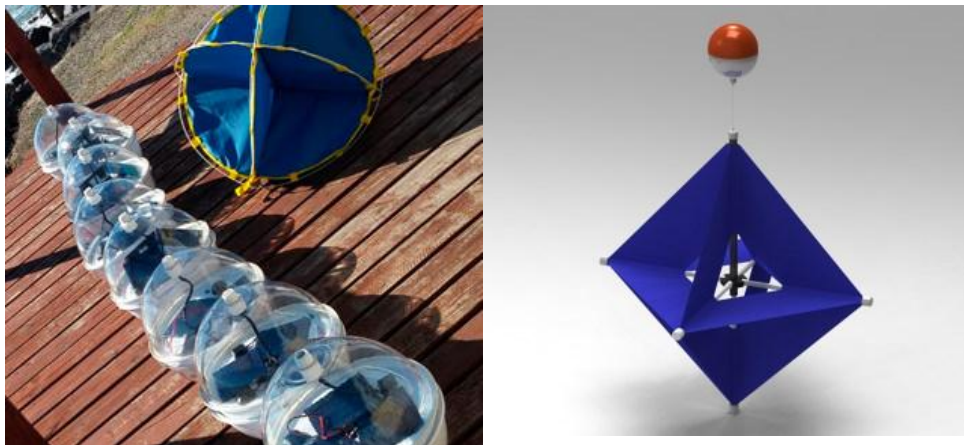
Figura 2. Izquierdo: Derivadores DORIS con su papalote (Foto de http://oorco.ens.uabc.mx/ ). Derecho: Esquema del derivador y papalote Microstar™ (Foto de https://www.pacificgyre.com/ ).
