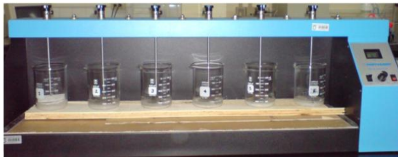
Figura 24. Equipo utilizado para las pruebas de jarra.
