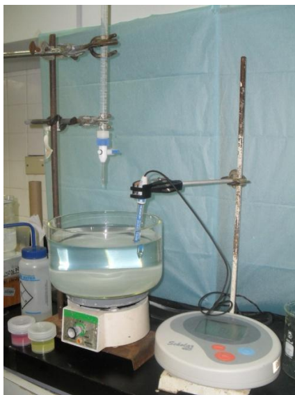
Figura 22. Adaptación en el laboratorio para la síntesis de estruvita.
