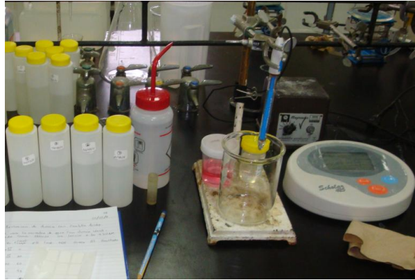
Figura 19. Adaptación para la medición de pH.
