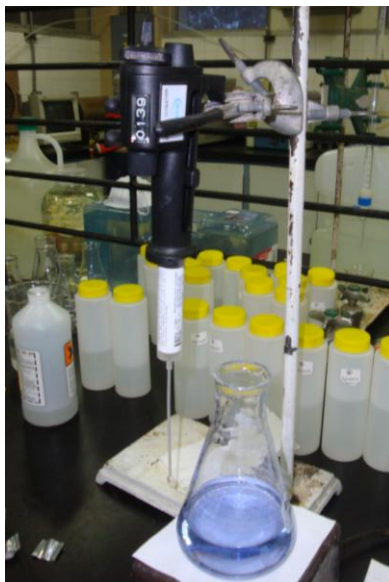
Figura 18. Adaptación para la determinación de dureza total.
