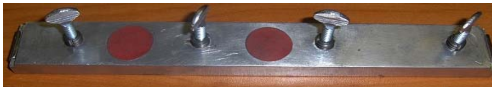
Figura 15. Tapa de la fixtura, para evitar el defecto por coplanaridad
