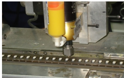
Figura 14. Shower Head. Proceso de inyección del epoxi
