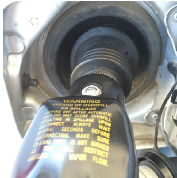
Figura 15. Recuperador de vapor de fase II incorporado a la pistola de despacho de gasolina (foto por Guillermo Oñate ©)
