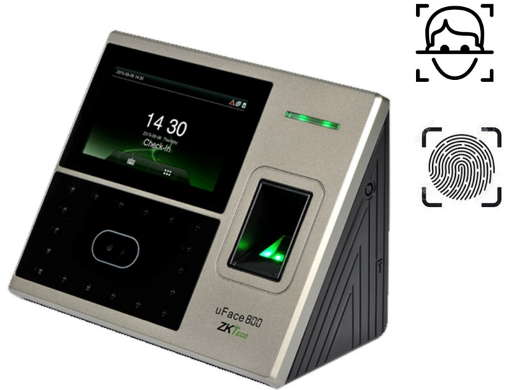
Figura 1.3: Sistema multi biométrico basado en huella dactilar y detección de rostro.
