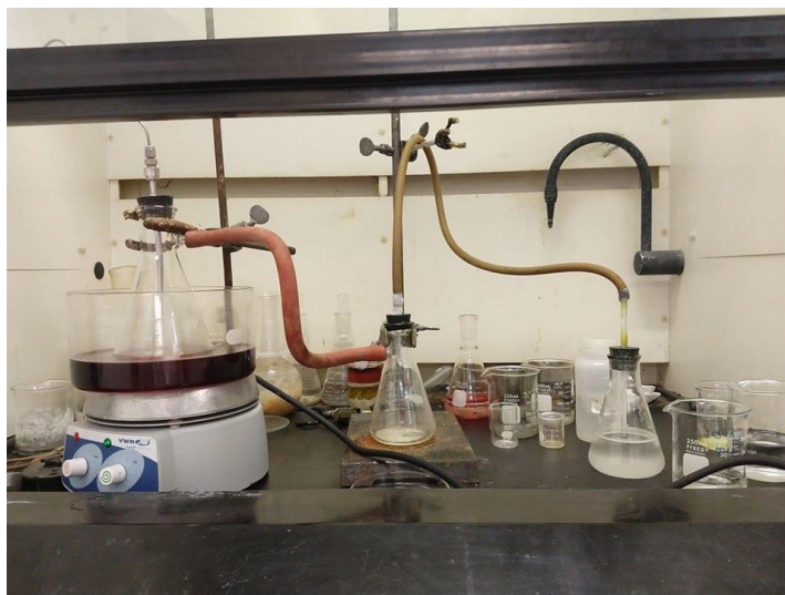
Fig. 5. Imagen del montaje del sistema para la síntesis del precursor ATM
