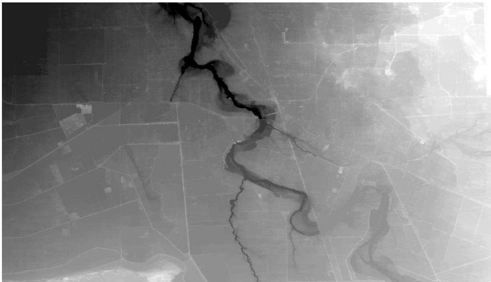
Figura 4. Ejemplo de MDE, complejo lagunar y Río Nuevo, Mexicali B.C, resolución de 5m., Fuente: INEGI
