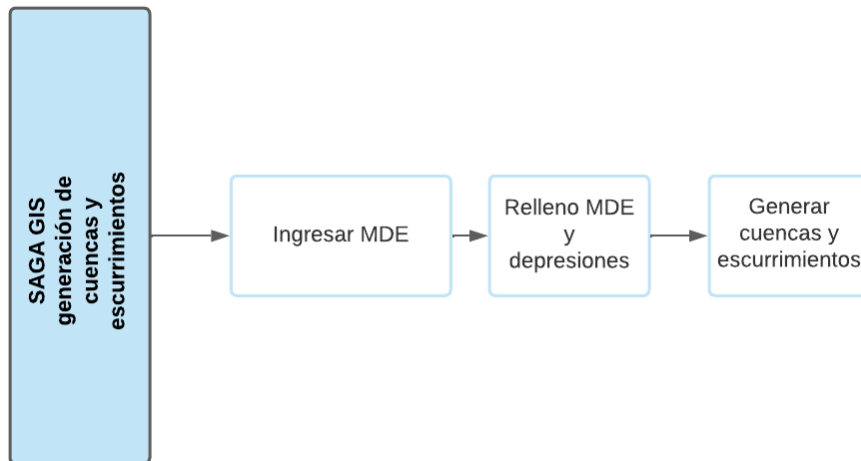
Figura 26. Diagrama de la generación de escurrimiento y microcuencas en el programa SAGA GIS, fuente: Elaboración propia.
