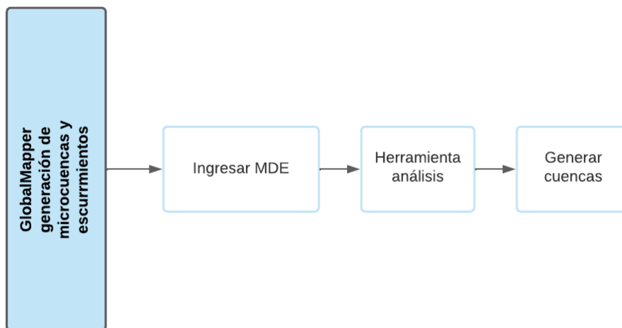
Figura 25. Diagrama de la generación de escurrimiento y microcuencas en el programa Global Mapper, fuente: Elaboración propia.
