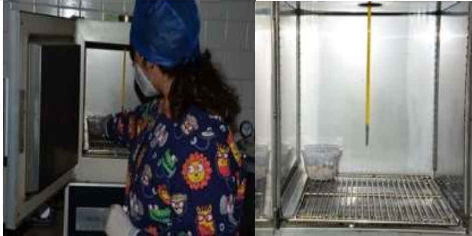
Figura 6. Almacenamiento de los especímenes. En la incubadora a 37° Celsius por cuatro semanas.
