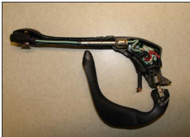
Figura 2.2 Auricular DUOPRO (corte seccional)
