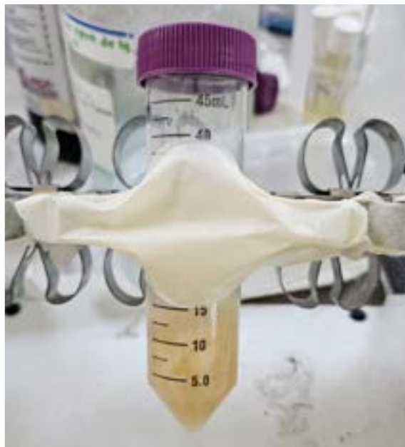
Figura 11. Agitación del Extracto hidroetanólico de Allium sativum . En la figura 11 se observa el extracto de ajo en el agitador barnstead thermolyne labquake.
