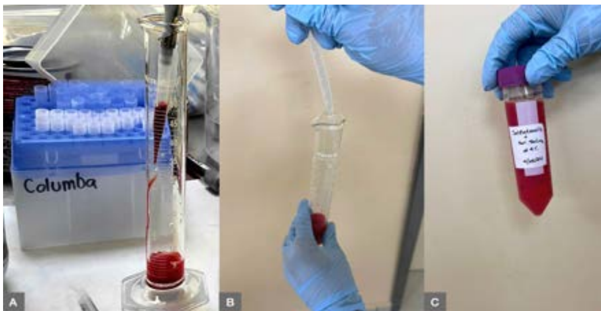
Figura 20. Solución madre de eritrocitos al 4 %. En la figura 20 Panel A: Extracción de 1.2 ml de eritrocitos de un tubo Eppendorf a una probeta graduada de 50 ml. Panel B: Preparación de la solución madre de eritrocitos al 4 % mediante la adición gradual de solución salina hasta alcanzar un volumen de 40 ml. Panel C: Almacenamiento de la solución de eritrocitos al 4 % en un tubo Eppendorf de 45 ml en refrigeración.
