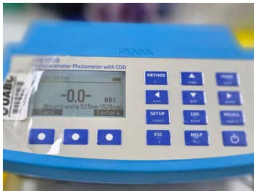
Figura 22. Espectrofotómetro lector de absorbancia. En la figura 22 se aprecia una fotografía del espectrofotómetro utilizado, modelo H183399 HANNA.
