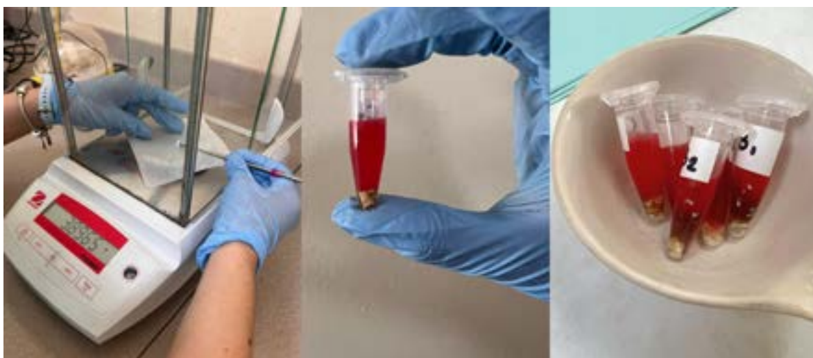
Figura 21. Mezclas de Hidróxido de calcio con suspensión de glóbulos rojos. En la figura 21 se muestra el proceso de pesaje de 50 mg de cada mezcla de \text{Ca}(\text{OH})_2 para luego colocarlas en tubos Eppendorf, donde se añadió la suspensión de glóbulos rojos.
