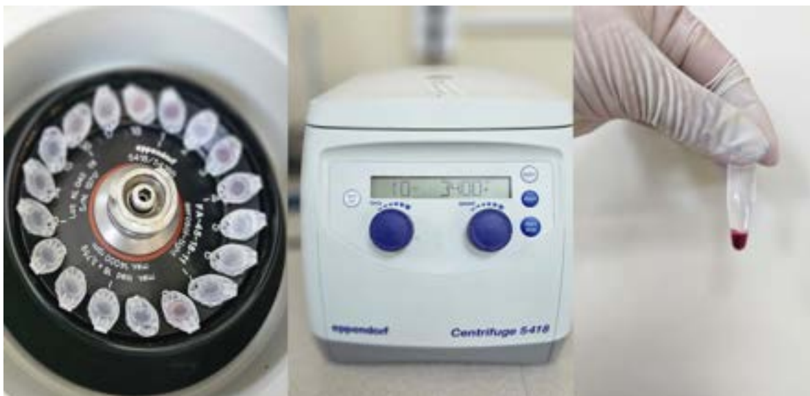
Figura 19. Centrifugación de tubos Eppendorf. En la figura 19 podemos observar la colocación de los tubos eppendorf para su centrifugación durante 10 minutos a 3400 rpm.
