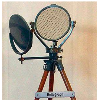
Figura 2.1: Heliógrafo, instrumento para hacer señales telegráficas por medio de la reflexión de los rayos del Sol en un espejo móvil.
