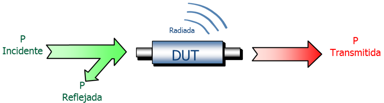
Figura 3. Ilustración de la potencia incidente, reflejada y transmitida.
