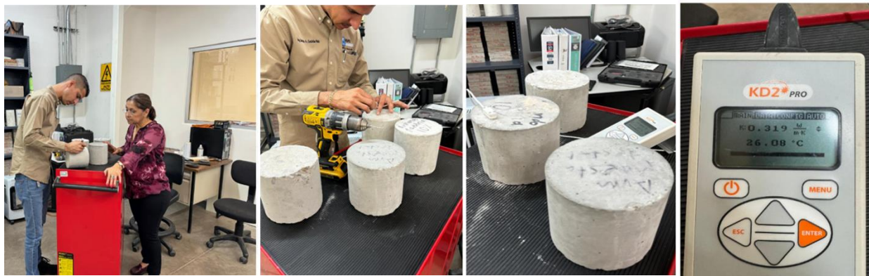
Figura 9. Medición de conductividad térmica de la mezcla propuesta en UNISON
