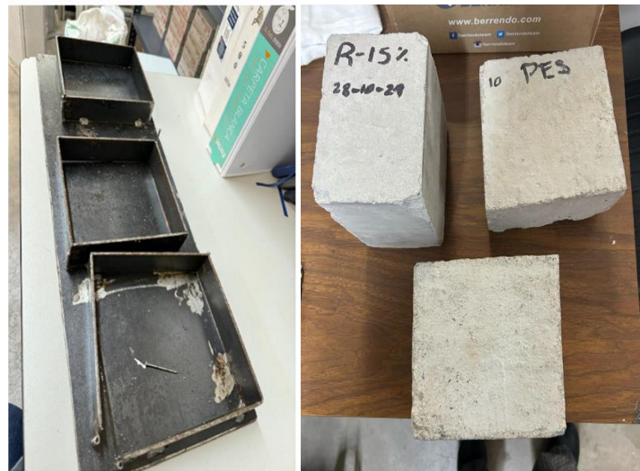
Figura 11. Moldes elaborados de 15x15x10 cms y especímenes para medición en λ-Meter EP500e.
