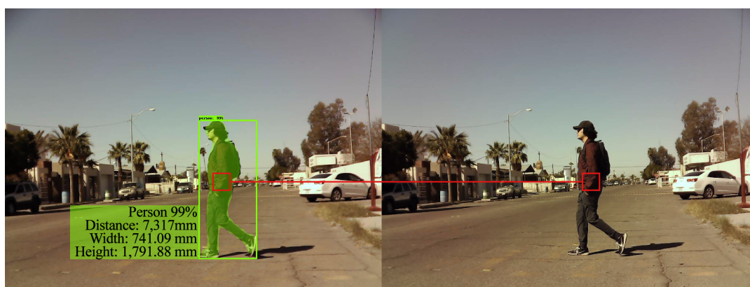
FIGURA 1.2: Detección espacial de objetos utilizando visión estereoscópica.
