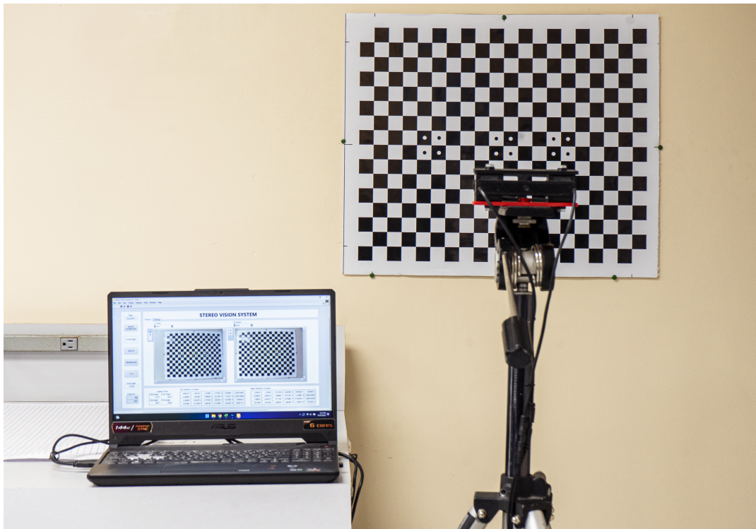
FIGURA 4.6: Configuración del experimento. Software del sistema de visión estéreo, sistema de visión estéreo y patrón.
