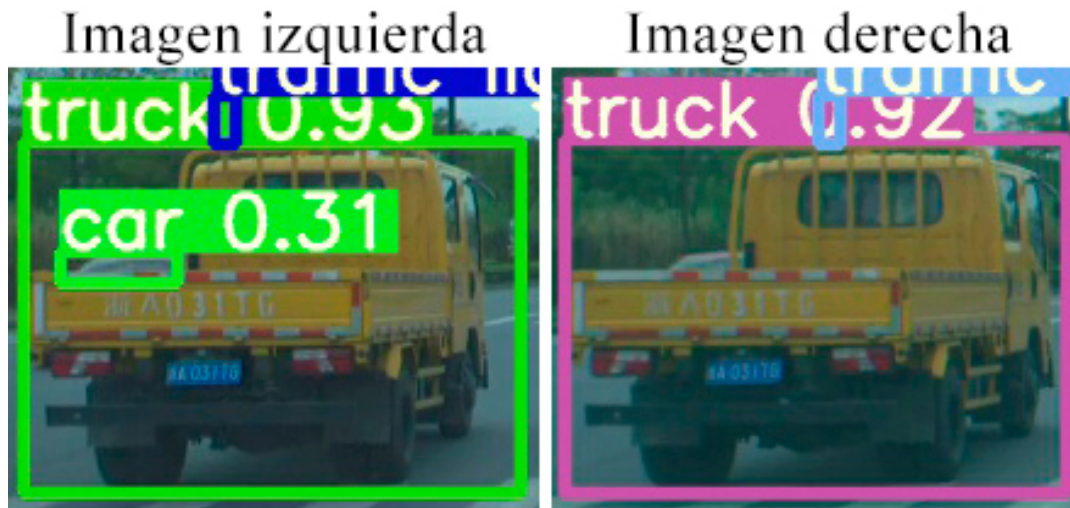
FIGURA 4.5: Algoritmo YOLOR detectando un objeto en la imagen izquierda y derecha donde se puede apreciar la diferencia en las cajas de detección (específicamente al lado derecho de cada imagen)
