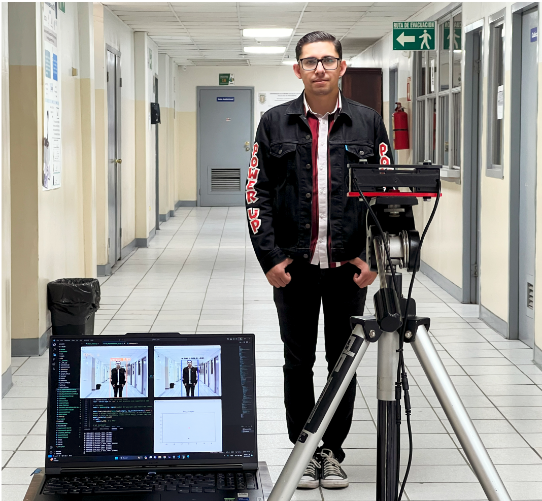
FIGURA 4.13: Configuración experimental que incluye el software del sistema de estéreo visión y detección de objetos, el prototipo del sistema de visión estéreo y la presencia del sujeto a ser detectado.
