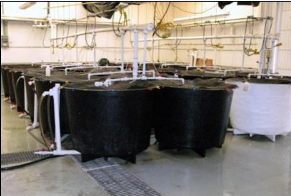
Figura 26. Sistema de tanques de fibra de vidrio utilizados durante el desarrollo del cultivo experimental de pargo lunarejo en las instalaciones del CIAD Unidad-Mazatlán (foto A. García-Ortega).
