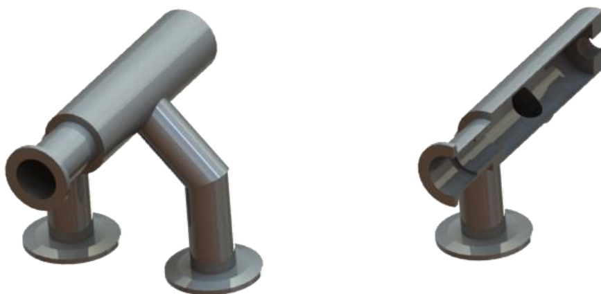
Figura 23: Vista tridimensional de unión tipo Y para el acoplamiento de nebulizadores gemelos hacia el tubo de cuarzo.
