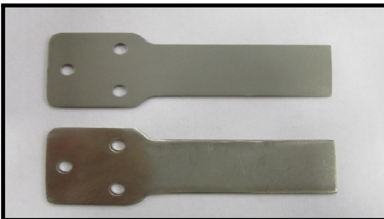
Figura 3.6. Pieza después del proceso de pasivate
