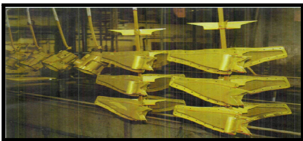
Figura 3.4. Preparación de partes para su anodizado con ácido crómico
