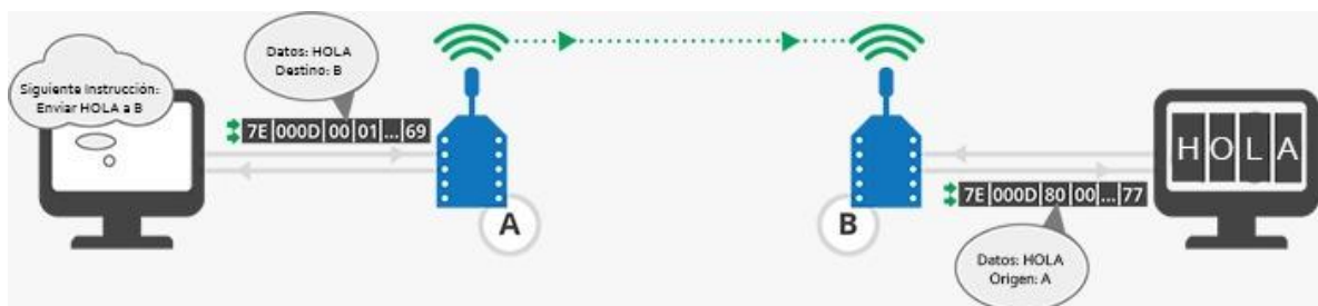
Fig. 3.7. Transmisión del módulo XBEE s3b PRO en modo API. (Digi,2014).
