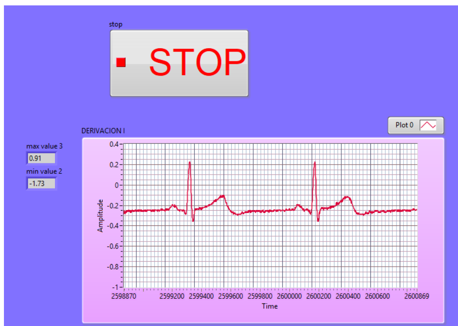
Fig. 4.34 .Imagen Plataforma Suma Biopotenciales LA-RA, derivación I paciente. Fuente: LabVIEW®.
