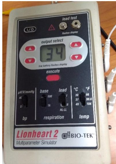
Fig.3.22. Configuración derivación II Simulador LionHeart2 ®. Fuente: Propia del Autor
