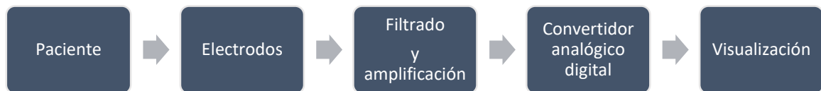
Fig. 2.1. Diagrama de bloques general de un electrocardiógrafo convencional. Fuente: Propia del Autor
