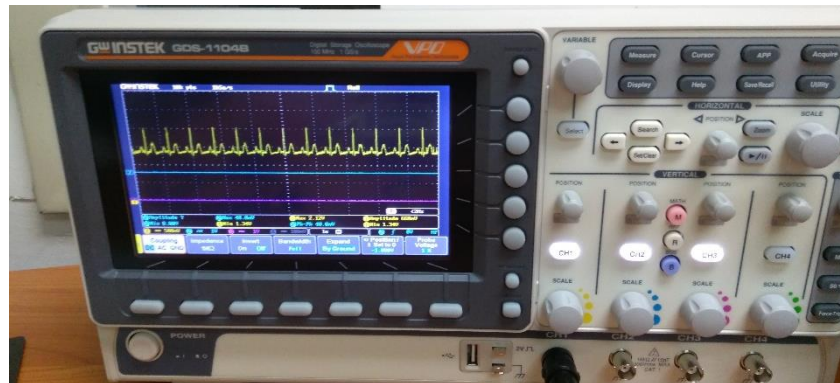
Fig. 3.21. Señal transmitida Simulador LionHeart2 ®.Fuente: Propia del Autor.
