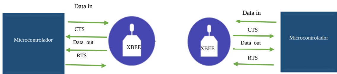
Fig. 1.14. Esquema representativo comunicación UART Xbee S3b PRO®. Fuente: Propia del Autor.
