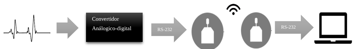
Fig. 3.14. Diagrama representativo para transmisión y recepción.
