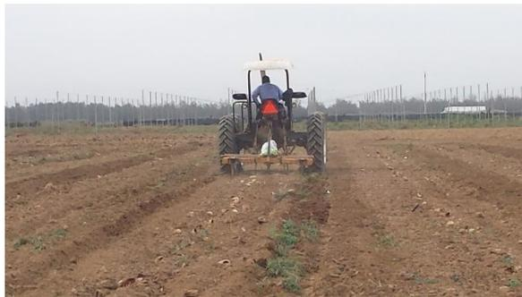
*Figura 26. Tractor con subsolador trabajando el terreno*
