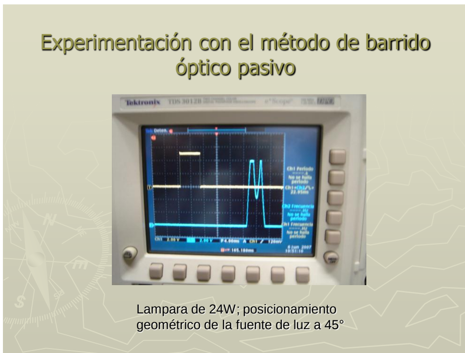
Figura 3.11 Señal real generada por el fotodetector
