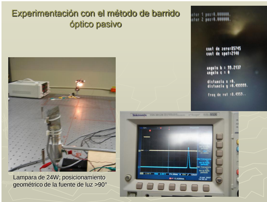
Figura 3.5 Medición de coordenadas para un ángulo mayor de 90°
