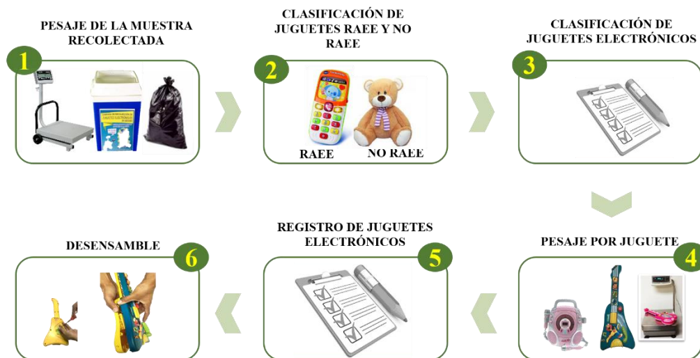
Figura 8. Etapas para la caracterización física de los juguetes electrónicos
