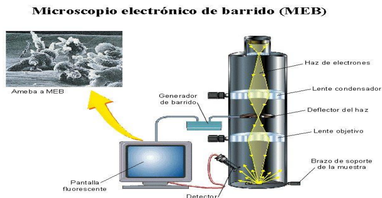
Figura 32. Componentes de la óptica del MEB convencional. (Fuente: http://almez.pntic.mec.es/~jrem0000/dpbg/1bch/tema1/micros-barr.JPG )
