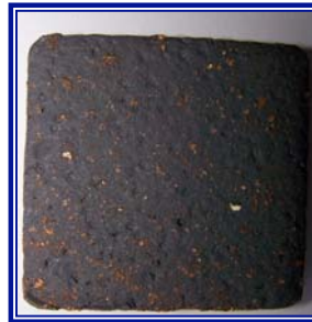
Figura 51. Fotografía de las losetas obtenidas con residuos Sn-Cu; 1A , 3A y 5A con 10 %p y 2A, 4A y 6A con 20 %p.
