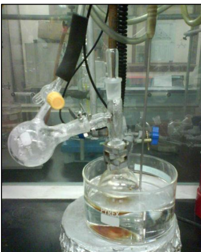
Figura 4.14. Destilador para la separación del extracto y etanol.
