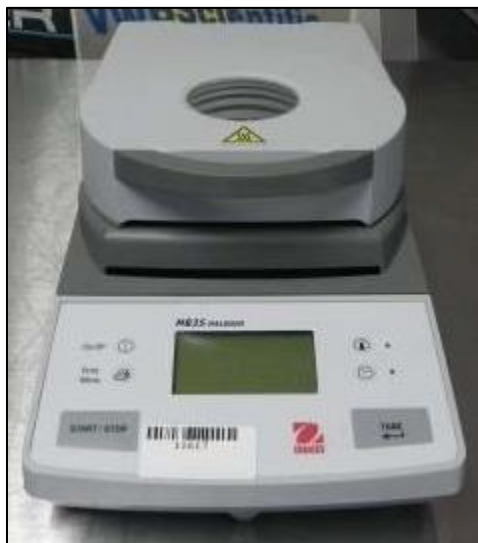
Figura 3.4.- Termobalanza para pruebas de porcentaje de humedad.
