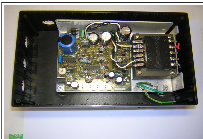
Figura 36. Fuente de voltaje HTAA-16W-AG ( +5V, \pm 12V ) montada en el Gabinete SIA .
