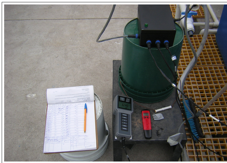
Figura 49. Sistema conectado e instalado, en la plataforma de investigación.
