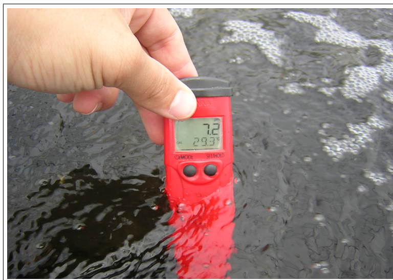
Figura 48. Medición de pH en el tanque con el pHmetro digital HANNA.
