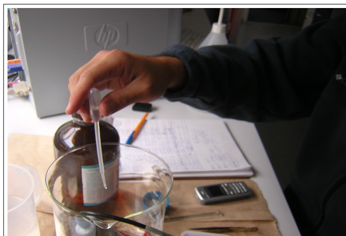
Figura 44. Se añade 1 ml de ácido clorhídrico para hacer ácida la solución.
