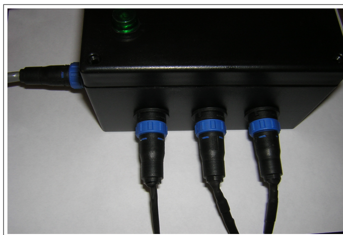
Figura 39. Gabinete S/A con los sensores y cable de salida conectados.
