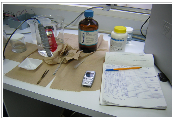
Figura 42. Prueba en laboratorio de pH con modificación abrupta de pH , de ácido a básico.
