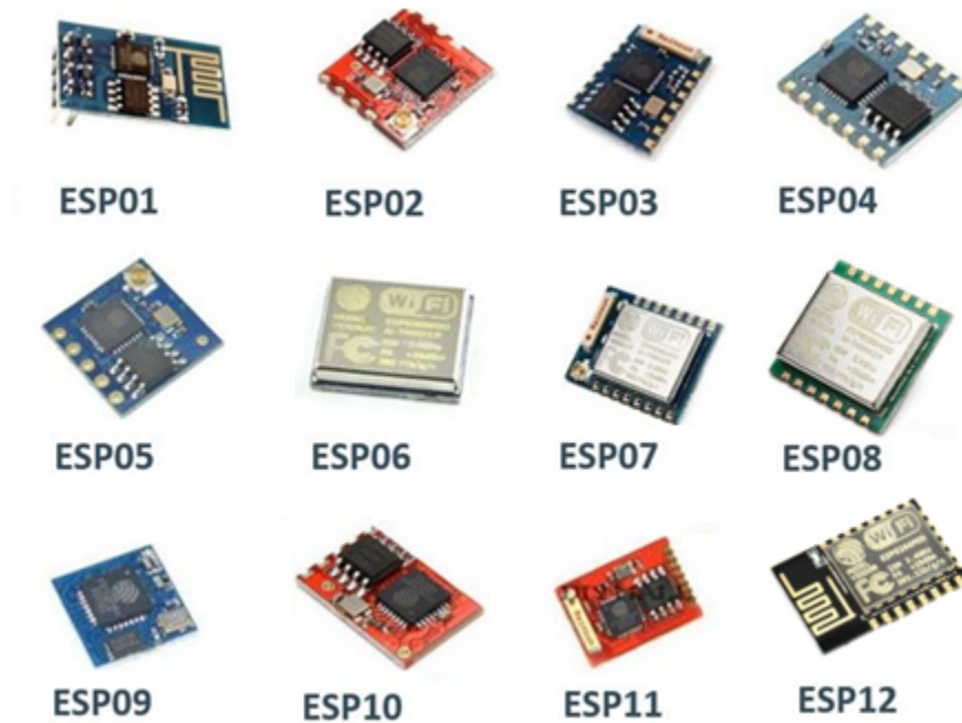
Figura 2.5: Variantes de módulos basados en el SoC ESP8266EX [7].
