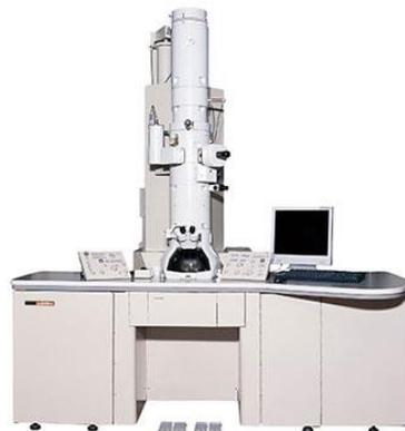
**Figura 12.** Microscopio Electrónico de Barrido-Transmisión JEOL JEM-2100.
