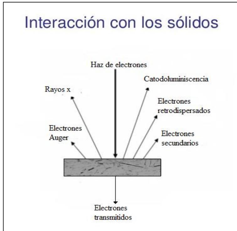
**Figura 10.** Señales originadas en la interacción haz-materia [60].
