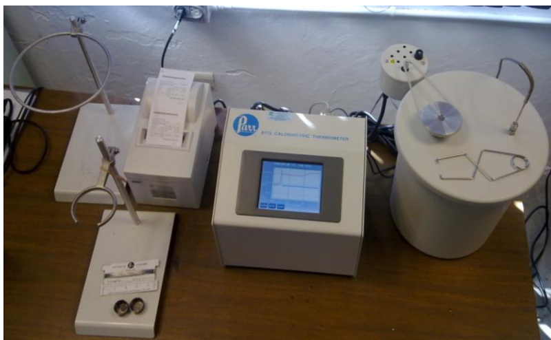
Figura 3.10. Equipo calorimétrico automático marca PARR
