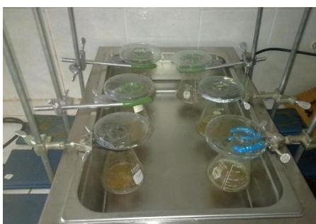
Figura 3.8. Digestión de muestra en el termo baño.
