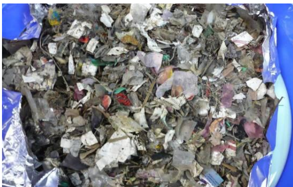
Figura 3.5 RSU digeridos secados a temperatura ambiente
