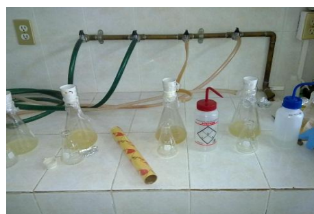
Figura 3.9. Filtración y lavado de la muestra digerida a vacío.
