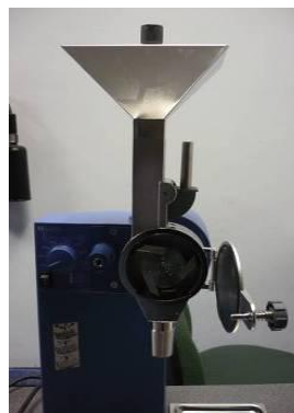
Figura 3.6 Molino de cuchillas marca Kika Werke
