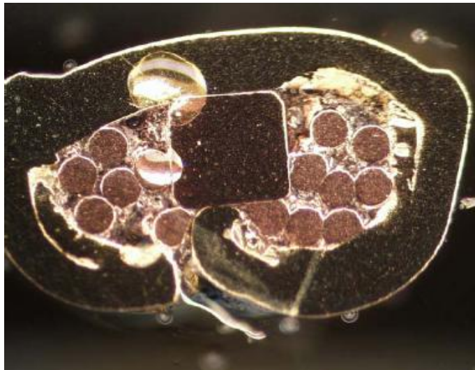
Figura 4.23 Fotomicrografía de la muestra A3 - T (260 amperes y soldadura actual) (8x) (se observa que los alambres de magneto no están aplastados).
