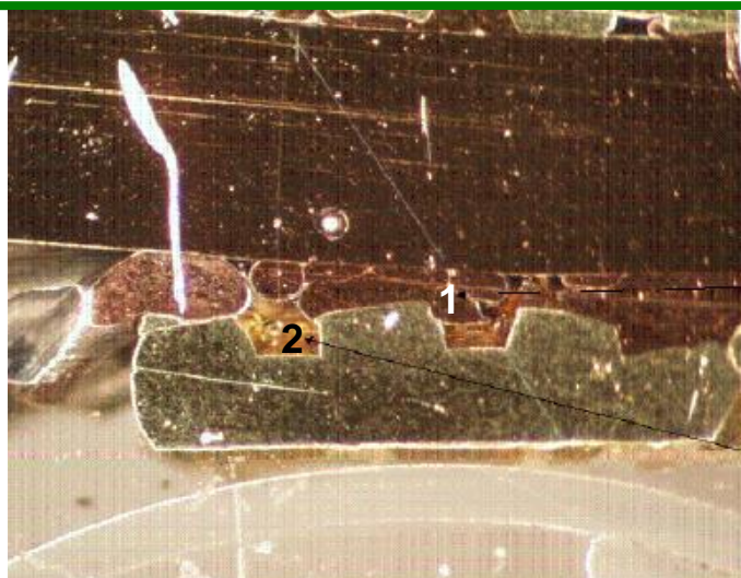
Figura 4.16 Fotomicrografía de la muestra P1 - A (proceso propuesto) (la flecha 1 indica el alambre de magneto aplastado entre el remache y el pin. No hay aislante visible entre los alambres de magneto. La flecha 2 indica el depósito de aislante de los alambres de magneto).
