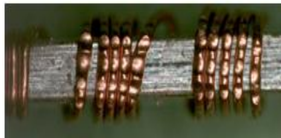
Figura 3.11 Remache con el parámetro propuesto.
