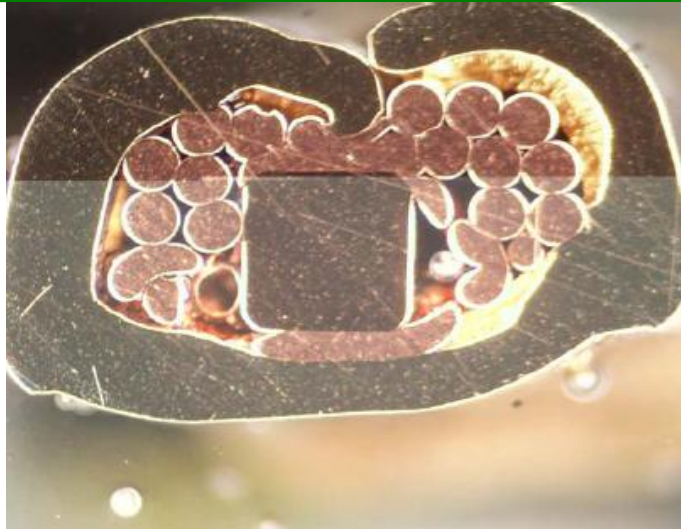
Figura 4.22 Fotomicrografía de la muestra A2 - T (200 amperes y soldadura actual) (8x) (se observa residuos de resina entre los alambres de magneto y el remache en la parte inferior derecha y fusión de los alambres de magneto y la banda con acabado dentado en la parte superior derecha).
