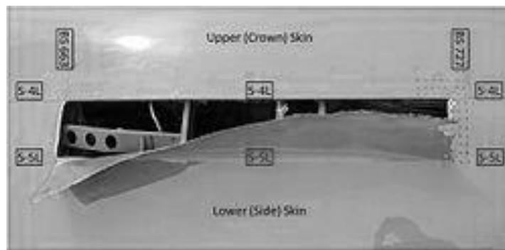
Figura 2-10 Esta foto NTSB muestra el agujero de aproximadamente 60 pulgadas (150 cm) en el fuselaje causado por el incidente [27]
