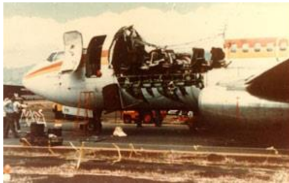
Figura 2-4 Foto del daño del fuselaje en el vuelo 243 de Aloha Airlines [24] .
