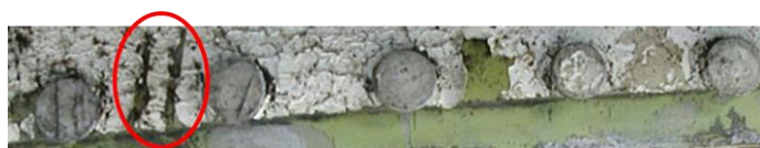
Figura 2-8 Foto de grieta propagada a lo largo del rasguño de la piel justo fuera de la línea de remaches [25]
